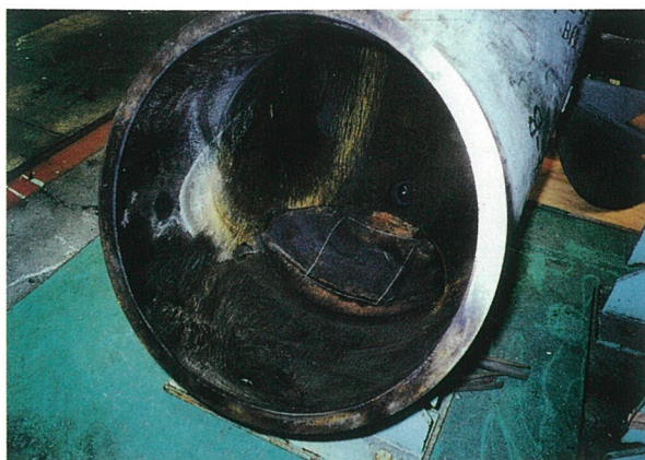
既設管(使用16年:材質25Cr鋳鉄) 450A 板厚22mmが17mmに磨耗
