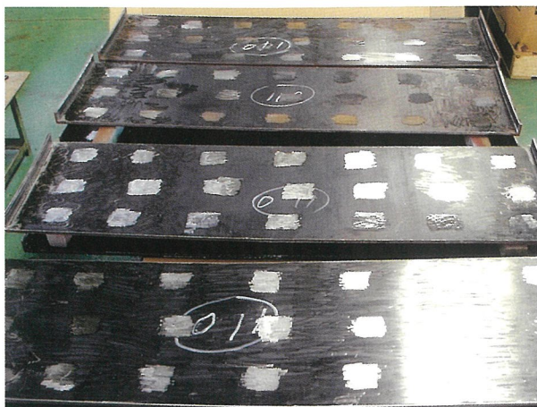
溶接取り付けの為の下地処理
