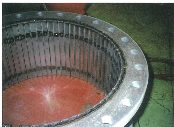
レール方式でセラミックタイル交換作業も容易
